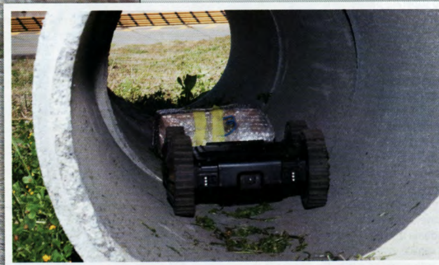
Il TRP-3 è difficilmente rilevabile dal nemico grazie alle basse emissioni acustiche dei suoi motori elettrici di tipo brushless. Sotto: il TRP-3 è in grado di penetrare anche in ambienti angusti alla ricerca di trappole esplosive.
