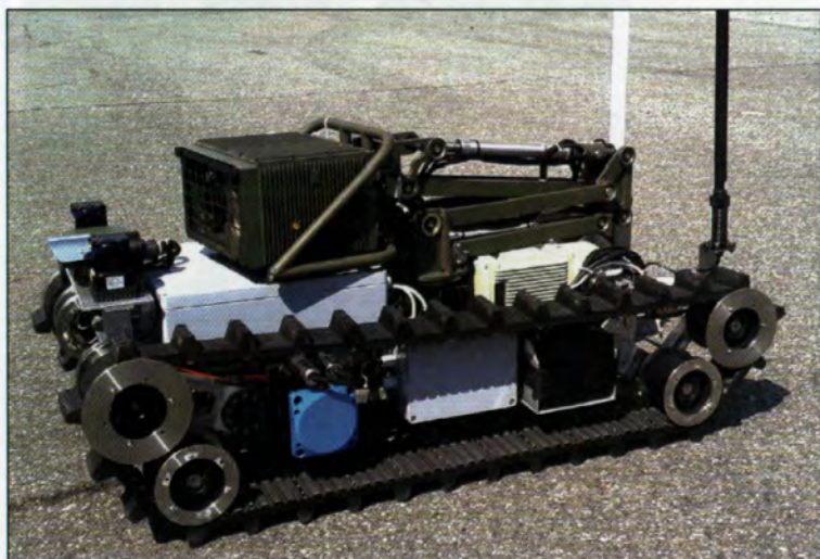
Un prototipo del TRP-2 RISTA con il braccio meccanico dotato di sensore elettro-ottico Mini-Colibri, in posizione ripiegata.
