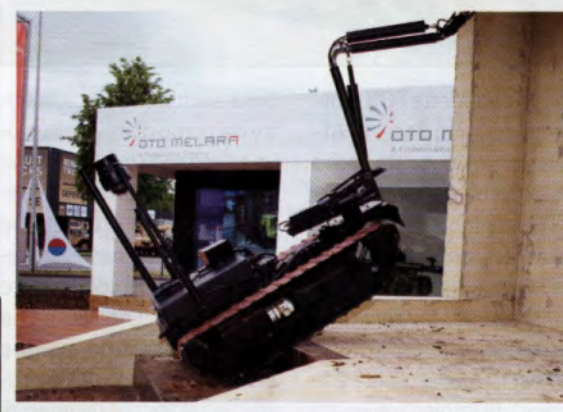
Vista posteriore di un TRP-2 Combat. Notare l'alloggiamento per l'arma principale sul quale è installata una mitragliatrice Minimi da 5,56 mm. Sopra: un TRP-2 HD impegnato in una dimostrazione di mobilità. In alto: il TRP-2 può raggiungere la velocità di 15 km/h e superare pendenze del 100%.
