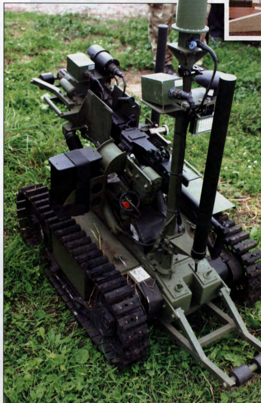
Vista posteriore di un TRP-2 Combat. Notare l'alloggiamento per l'arma principale sul quale è installata una mitragliatrice Minimi da 5,56 mm. Sopra: un TRP-2 HD impegnato in una dimostrazione di mobilità. In alto: il TRP-2 può raggiungere la velocità di 15 km/h e superare pendenze del 100%.
