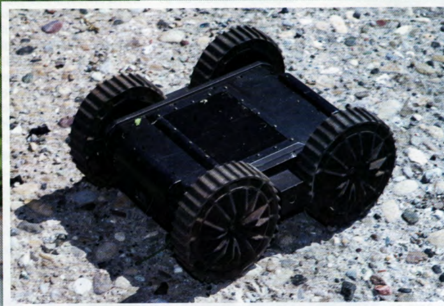
Il TRP-3 è difficilmente rilevabile dal nemico grazie alle basse emissioni acustiche dei suoi motori elettrici di tipo brushless. Sotto: il TRP-3 è in grado di penetrare anche in ambienti angusti alla ricerca di trappole esplosive.
