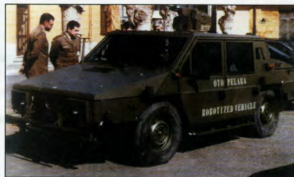
L'autovettura blindata OTO R 2,5 Gorgona nella versione remotizzata da Oto Melara alla fine degli anni '80. Sotto: il TRP-2 può essere smontato in parti trasportabili dalla squadra di fanteria all'interno di zaini.
