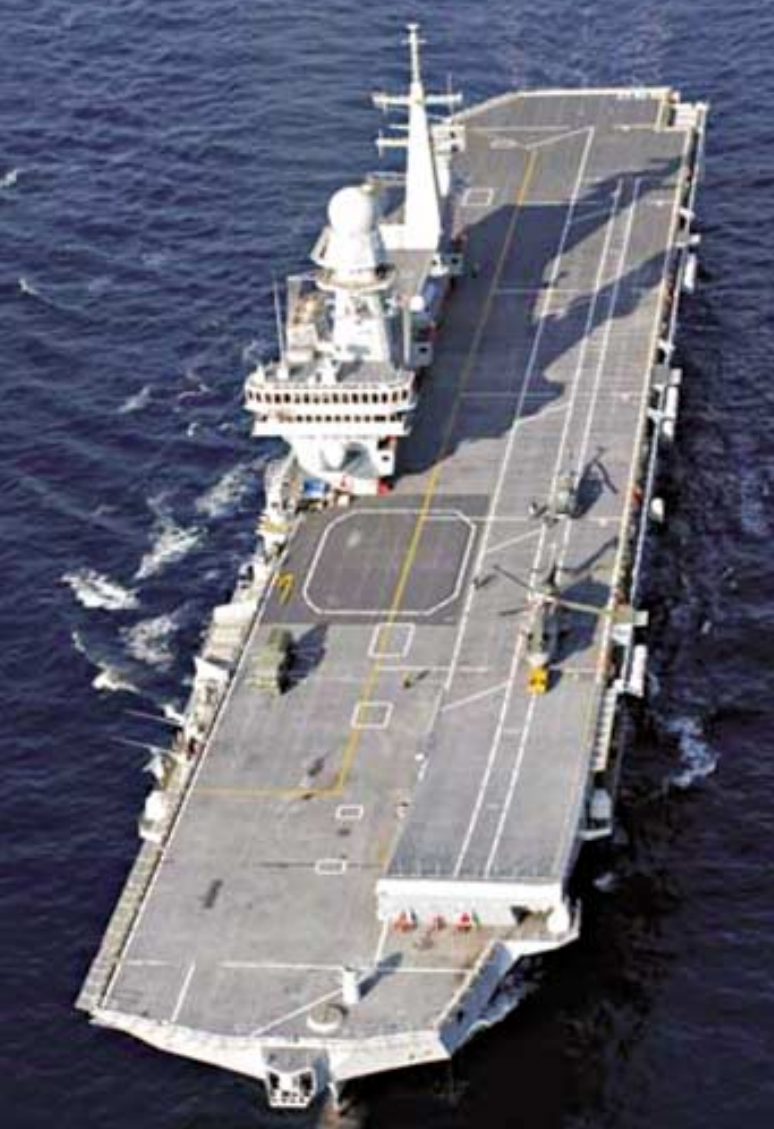
Questa buona immagine dall'alto del Cavour evidenzia, nella loro completezza, le strutture del ponte di volo, dalla pista continua da poppa a prora allo ski-jump
